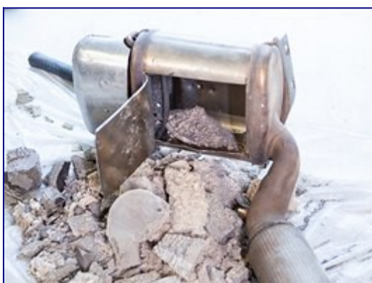
Filtr pevných částic s odstraněnou vložkou
